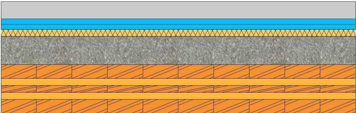
**Abbildung 1: Vertikalschnitt BHB 1.10 20 mm MiWo, light/Öko/Öko Plus, 50 mm Estrich**
